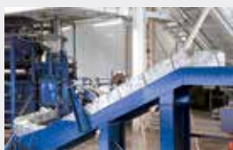
Pressen: Komprimierung leichter Fe-Metalle auf stahlwerksnormierte Größen. Senkt Frachtkosten und beschleunigt die Beschickung in der Stahlherstellung
