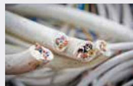
Kabelaufbereitungsanlagen: Lösen der Kabelummantelungen von Kupferlitzen, Rückgewinnung des Kupfers
