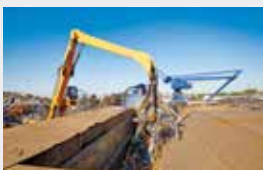
Scheren: Anlagen (bis zu 1.400 t Scherkraft) und Bagger mit hydraulischen Scheren. Zerkleinerung sehr grober, schwerer Materialien (z. B. Schienen oder Eisenbahnwaggons)
